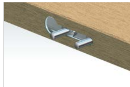
Mise en place du 2ème boulon à embase.
