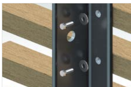
Mise en place de la structure portante. Les trous pré-perçés sont plus larges (2 à 4 mm) que l'axe du boulon pour permettre l'expansion de la planche. Rondelle obligatoire.
